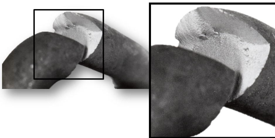
Rys. 11. Strefa całkowitego przełomu ogniw pod kątem około 45° w stosunku do powierzchni [opracowanie własne]
