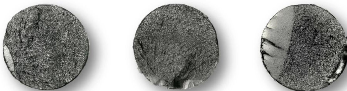
Rys. 10. Widok stref zmęczeniowych pęknięć pręta ogniw o zróżnicowanym położeniu ognisk pęknięć i wielkości strefy przełomu zmęczeniowego [opracowanie własne]
